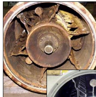
Rotores antes y después de darles servicio por LCI
