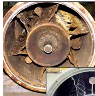
Rotores antes e após o serviço da LCI.
